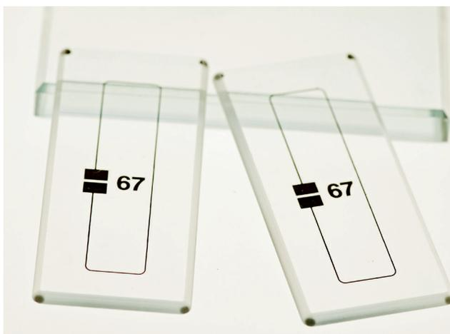
**Sitec AR 2** ist ein pyrolytisch beschichtetes leitfähiges Floatglas, welches beidseitig interferenzoptisch entspiegelt wird. Hierdurch erhält das Glas leitfähige Eigenschaften und eine geringe Restreflektion bei guter Transmission.
